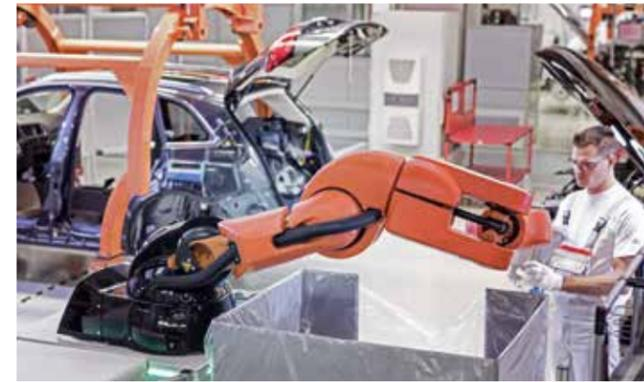
Les systèmes de coopération homme-robot sont une dominante de la robotique. On voit ici le système PART4You du constructeur automobile Audi : un bras robotisé qui tend à l'homme les outils dont il a besoin. Photo : AUDI AG
