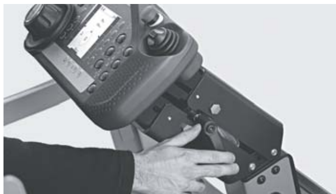
Positionnement du pupitre de commande réglable sur trois axes
